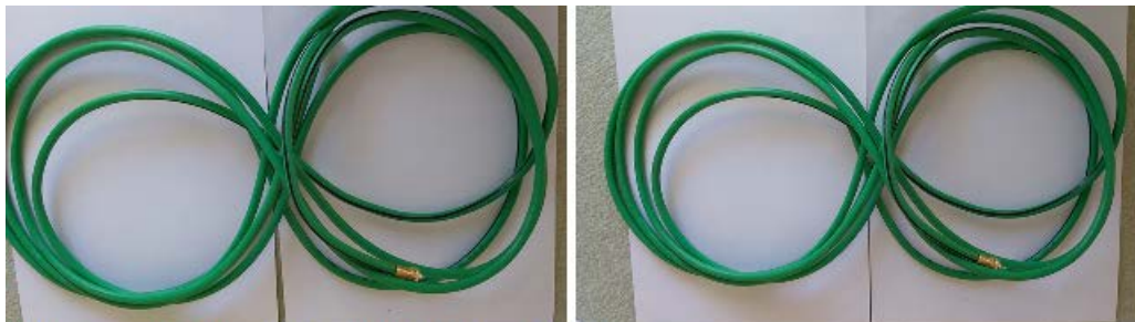
Resim-2: Kablonun 8 şeklinde kangal edilmesi
