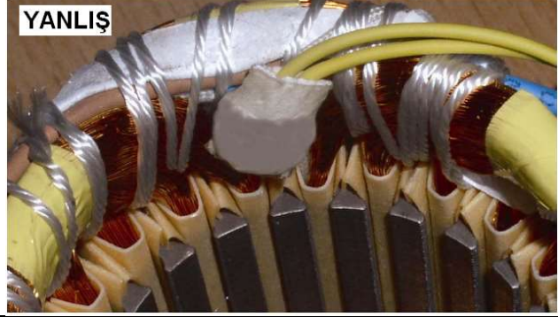
Resim me05: Sargılara termiztör yerleřtirilmesi
