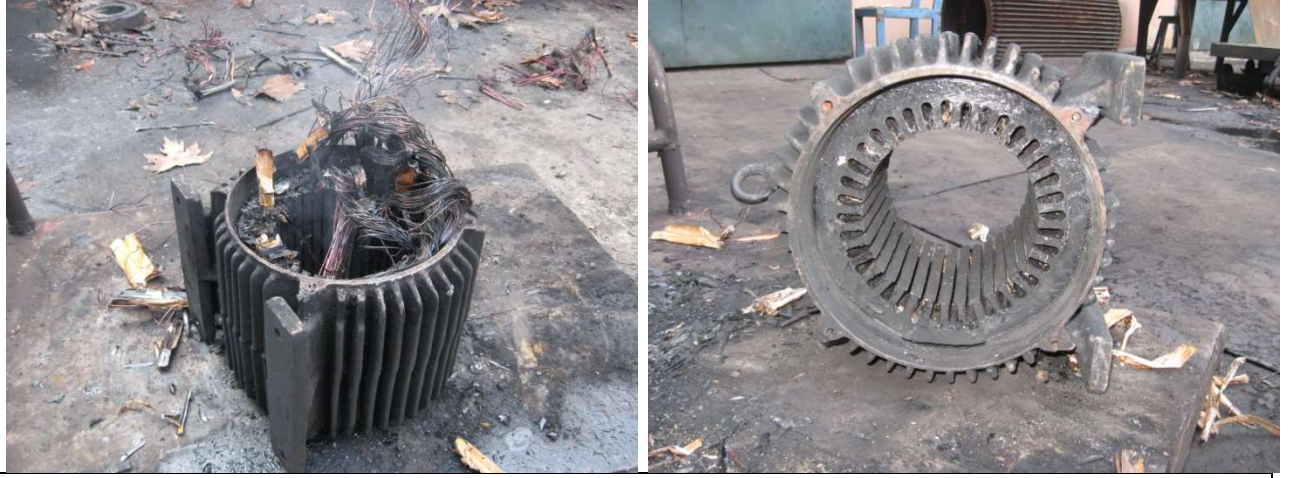
Resim me02: Yakılarak sökülen sargı ve demir nüve örneği
